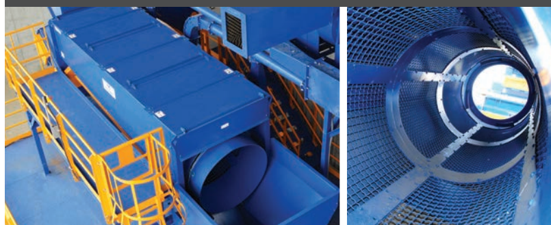
Le crible rotatif pour le traitement des particules fines
