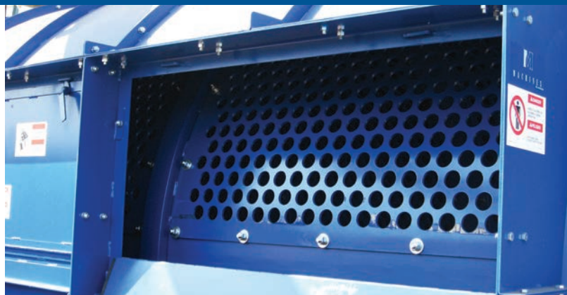
Portes d'accès de chaque côté facilitant l'entretien
